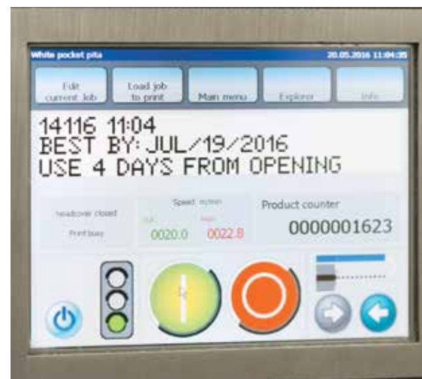
L'écran de l'imprimante à jet d'encre Leibinger affiche les informations relatives à la date de péremption des pain Pita sandwich.
