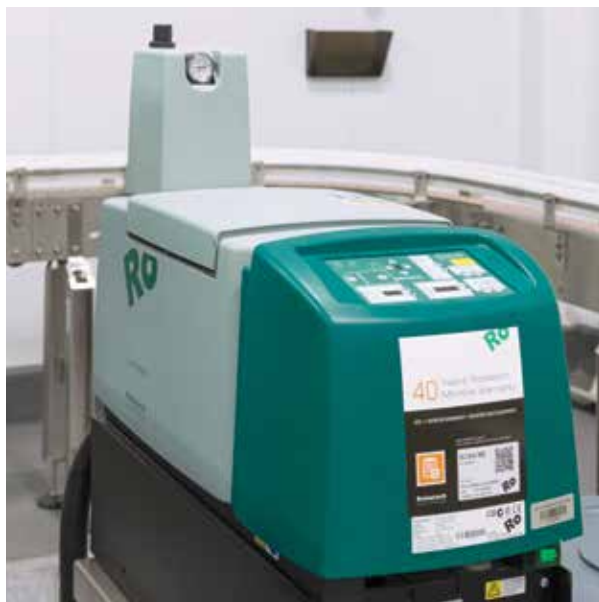
Un système d'adhésif Robotech est utilisé pour sceller les boîtes de produits.
