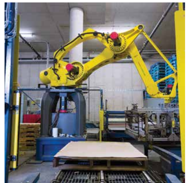
Une station de palettisation sécurisée.
