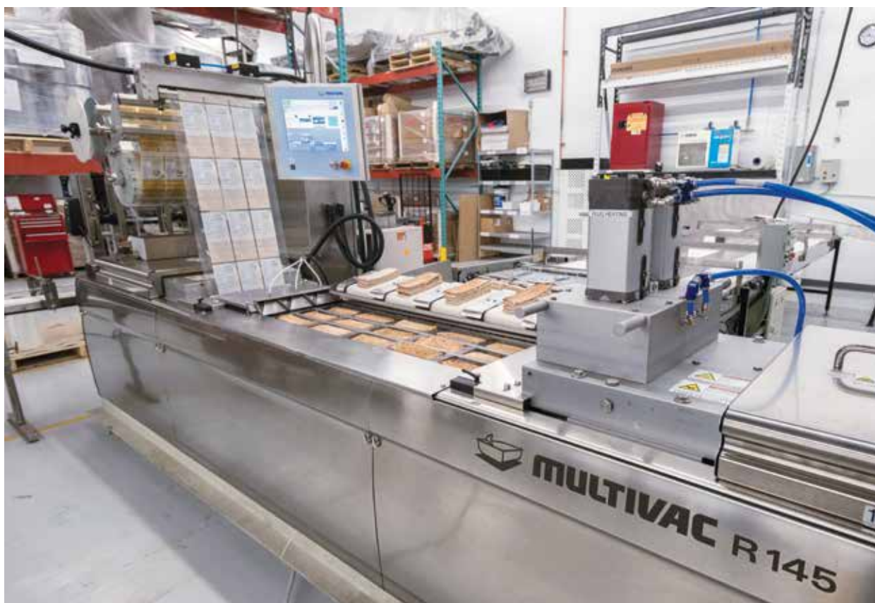
L'usine de Amoun Foods, à Lachine, utilise une thermoformeuse de marque Multivac, modèle R145.
