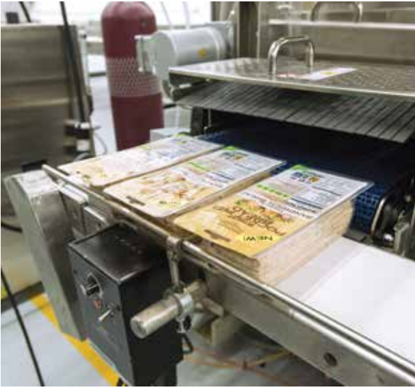
Des emballages de pain Pita sandwich à la sortie de la thermoformeuse de marque Multivac, modèle R145.
