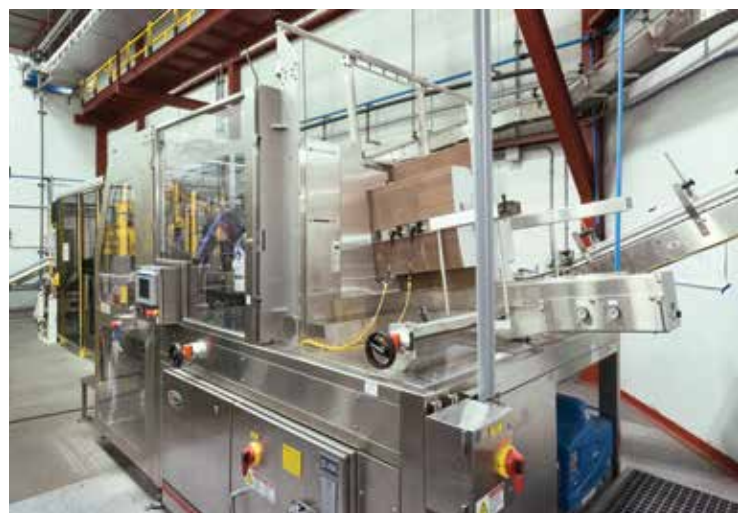
De haut en bas : boîte de gourdes de compote de pommes, gourdes de compote de pommes, une cartonneuse de caisses de marque Delkor modèle Trayfecta.
