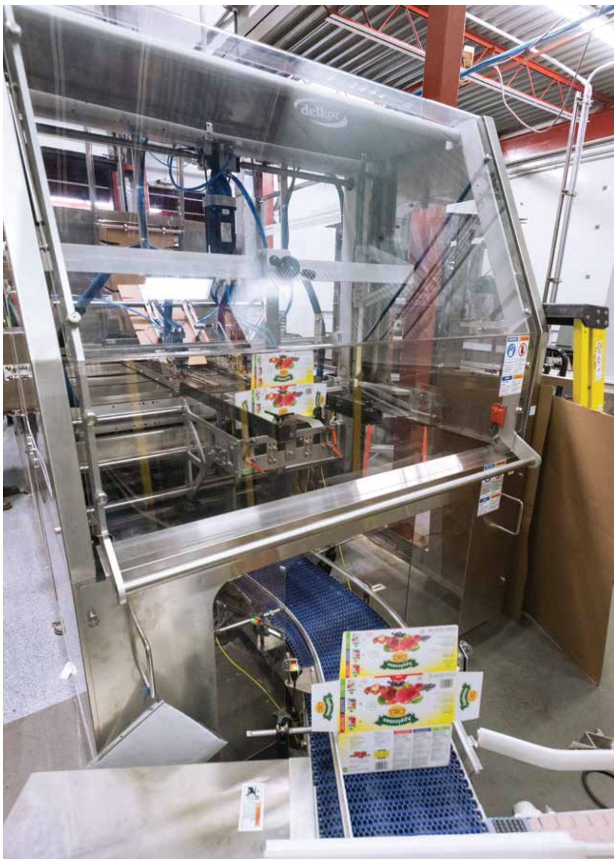
Des boîtes de gourdes de compote de pommes formées par la cartonneuse de caisses de marque Delkor.
