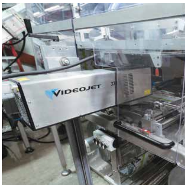
Un codeur laser Videojet 3330 imprime des codes de lot de production sur le film plastique qui servira à former des gourdes de compote.
