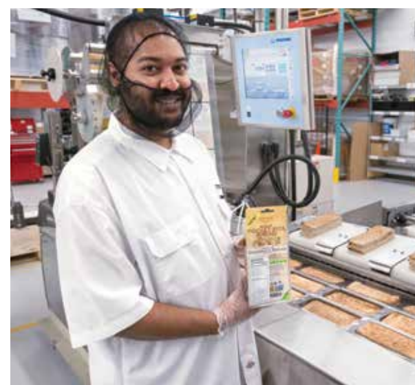
Les emballages de pain Pita sandwich sont réalisés sur une thermoformeuse de marque Multivac, modèle R145.
