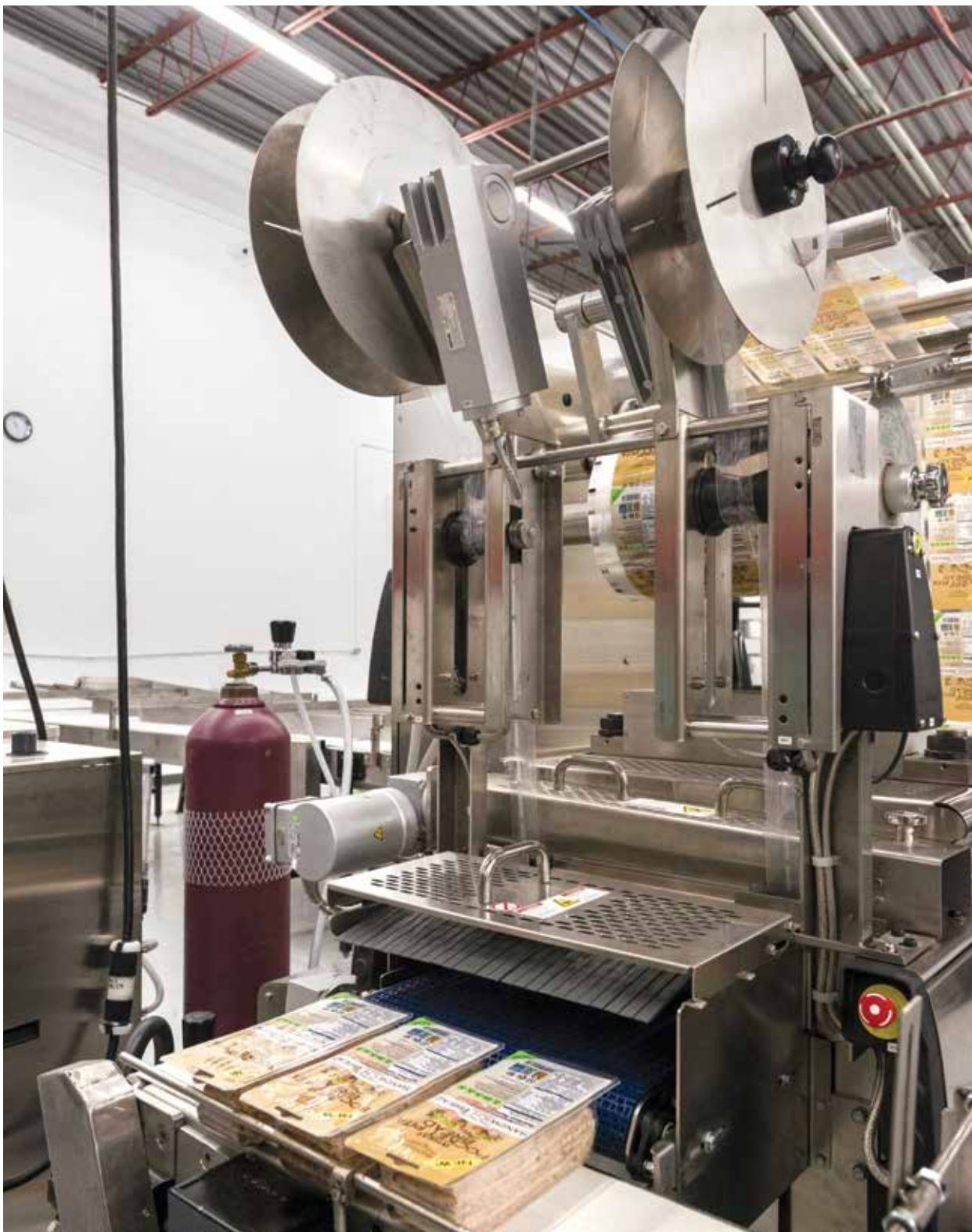
Des emballages de pain Pita sandwich à la sortie de la thermoformeuse de marque Multivac, modèle R145.
