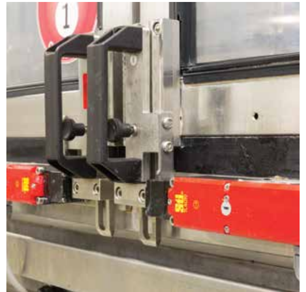
Un interrupteur de sécurité STI avec verrouillage sur la porte de protection TL4019 conçu et fabriqué par Omron.
