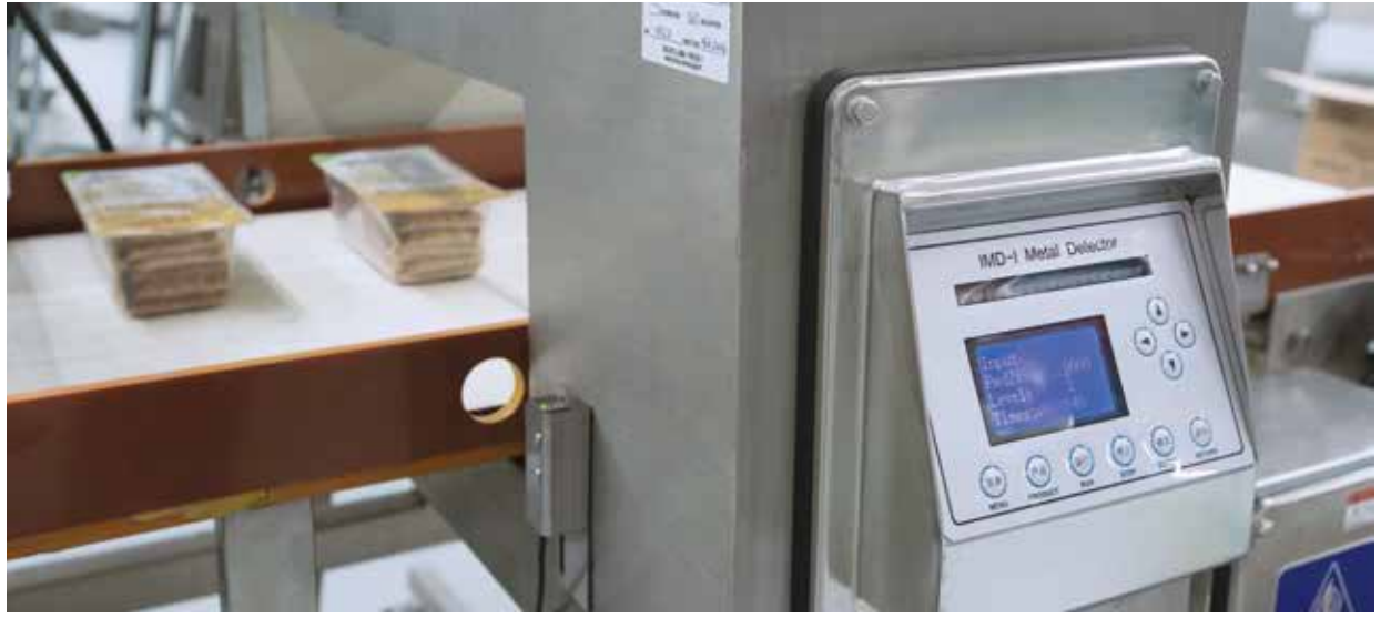
L'usine de Amoun Foods utilise un détecteur de métal de marque Loma.
