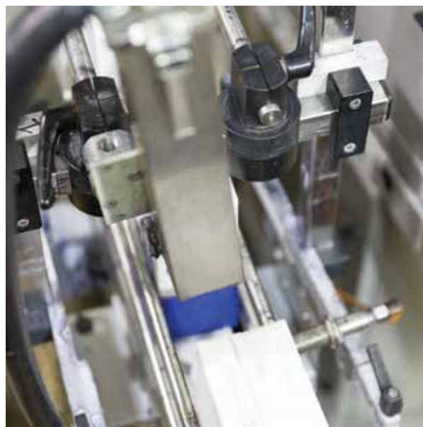
Un système de codage à haute vitesse Domino sur une ligne d'embouteillage Tetra Pak à l'usine Kerry Foods, à Sainte-Claire.
